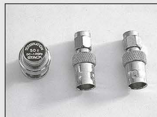
↑50Ωターミネーター。SMA-BNCコネクタ
